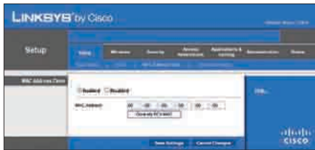
Setup > MAC Address Clone (Configuration > Adresse MAC dupliquée)
